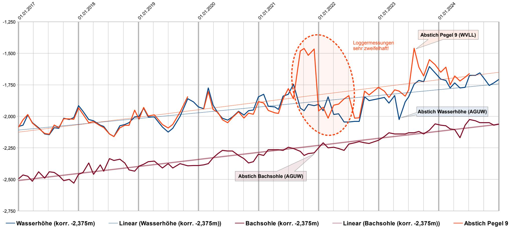
**Erkenntnis: Wasserstände AGUW / WVLL deckungsgleich bis Juli'2021; Bach verlandet zunehmend (nahezu gleichmäßige Drift)**
